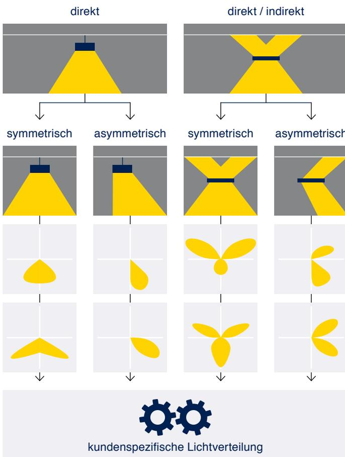
LGP koppelt Licht gleichmäßig und gerichtet über die gesamte Fläche aus. Lichteinspeisung kann über die Kante, über die Fläche oder in kundenspezifischer Variation erfolgen
