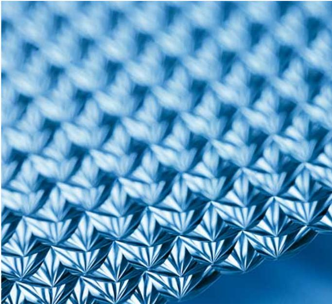
Das DDP bietet hervorragende Entblendungseigenschaften mit einer reduzierten Materialstärke von nur 2 mm. Konkave Oberflächenstrukturen mit durchgehenden Stegen sorgen dabei für nahezu die gleiche mechanische Stabilität wie bei unseren bewährten Strukturen in 3 mm Dicke. Eine reduzierte Aufbauhöhe und ein geringeres Gewicht ermöglichen noch schlankere Leuchtenlösungen.
